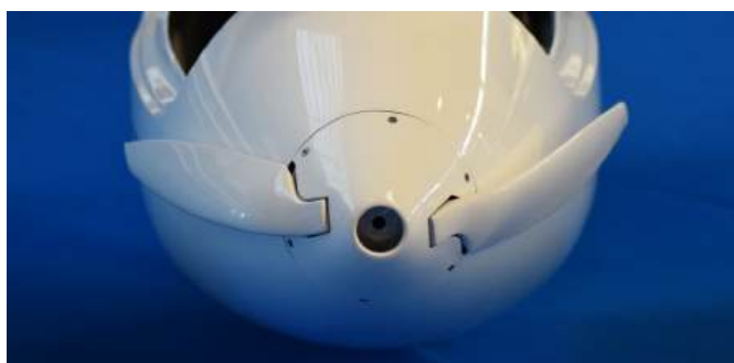
Rys. 2. Polski szybowiec Diana 2 z silnikiem FES
