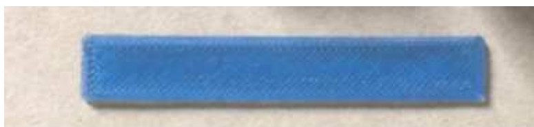
Rys. 3. Wydrukowana 3D próbka do testu efektu pamięci kształtu.
